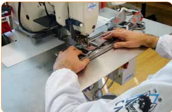
Definizione delle cuciture da utilizzare sulle imbracature. Working on the stitching to be used on harnesses.
